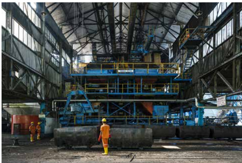
SIPEF - Lossen van kooien van gesteriliseerde trossen in dorstation
